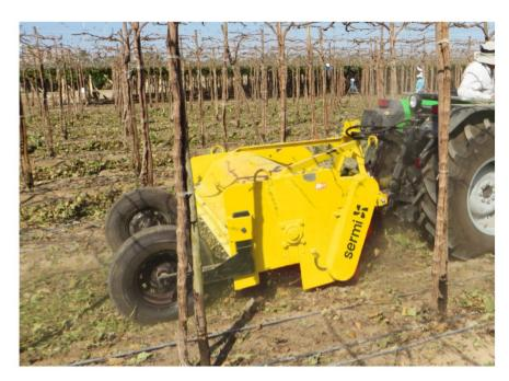
Las picadores de poda son implementos trituradores para la poda de Vid, cambiándole el sistema de martillos o cuchillas son utilizadas para triturar poda de cítricos, olivos y paltos, de esta manera se tiene un implemento multifunción capaz de triturar restos de cosecha e incluso espárragos, consta de un chasis extra reforzado y cuchillas de acero anti abrasivo.
