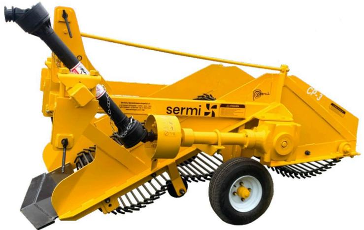
Cosechadora de enganche de tres puntos, diseñada para todo tipo de terreno.
